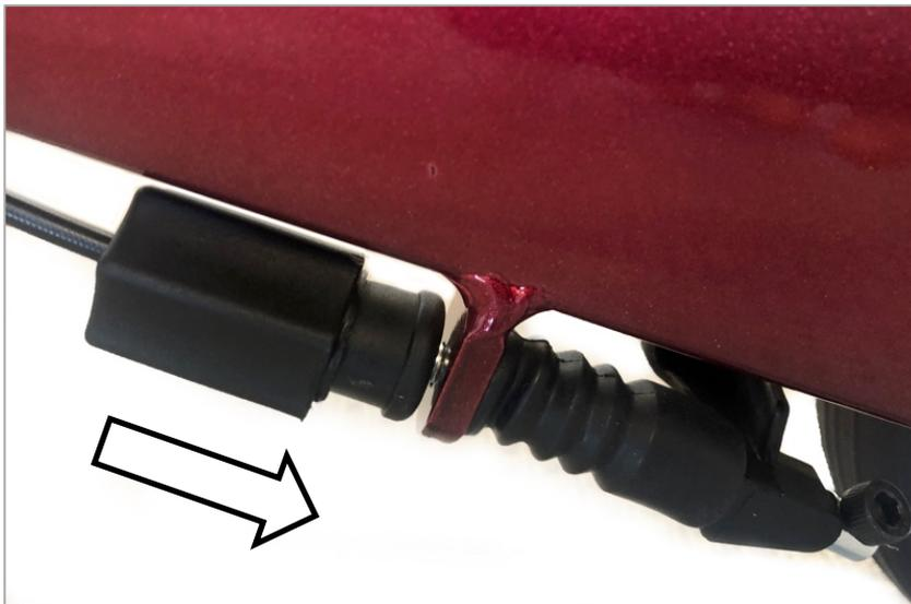
1. Schieben Sie die Kunststoff-Sechskanthalterung über die Kunststoffschraube. Nun können Sie mit Hilfe der Sechskantverkleidung die Schraube nach rechts, zum Lockern der Bremskraft oder nach links, zum Verstärken der Bremswirkung einstellen.
