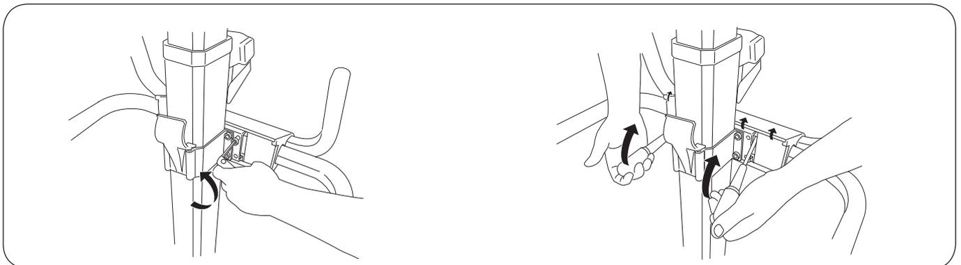
A. Lösen Sie die zwei M8-Schrauben in der Armstützenhalterung an beiden Seiten der Hubsäule.
